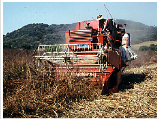
(Foto 1) Màquina convencional de batre cereals collint llavor d'enclóver
